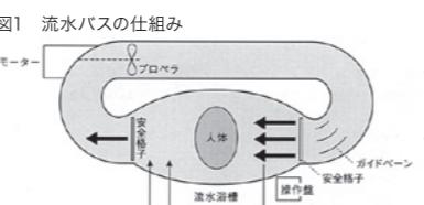
図1 流水バスの仕組み
